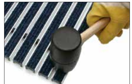
Positionner la nouvelle bande reps après avoir collé le ruban adhésif double face sur le profilé. Terminer la mise en place à l'aide d'un maillet caoutchouc pour bien plaquer l'insert reps dans la cavité du profilé.
